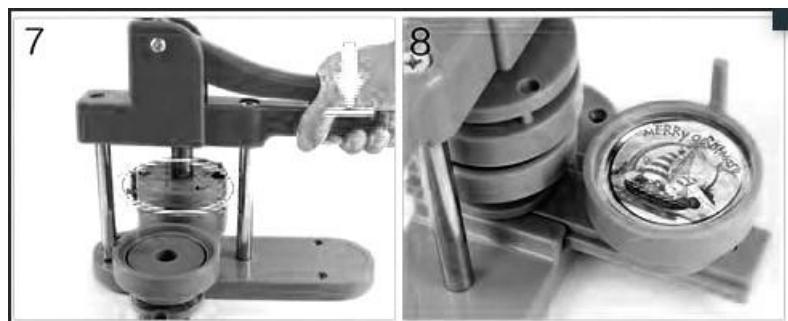
[5.6.7] Положите прокладку на нижнюю часть железного значка. Пластиковая нижняя часть значка не требует прокладки. Положите пластиковую прокладку в правую форму, затем положите часть значка с булавкой, стороной с булавкой вверх. Сдвиньте правую форму, чтобы она оказалась под верхней формой, нажмите на ручку; верхняя форма должна быть закрыта, как показано.
